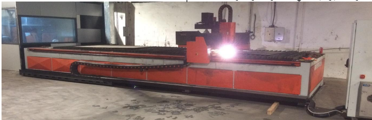
شكل (1) يوضح منظر ماكينة القطع بقوس البلازما باستخدام التحكم الرقمي بالكمبيوتر.
