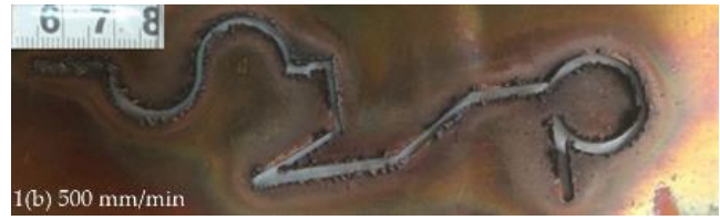
شكل (8) يوضح منظر القطع بقوس البلازما للعيينة 1 من الـ Cu1 ومن الخلف 1(b) عند سرعة 500مم/د وبقدرة تيار 30 أمبير.
