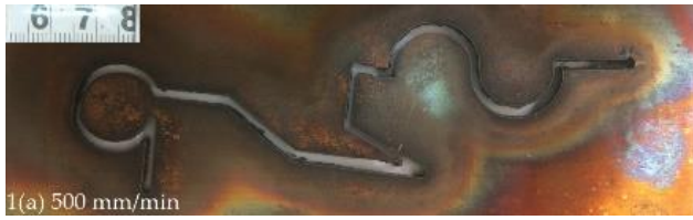
شكل (8) يوضح منظر القطع بقوس البلازما للعيينة 1 من الـ Cu1 ومن الخلف 1(b) عند سرعة 500مم/د وبقدرة تيار 30 أمبير.
