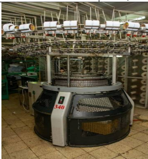
شكل (1) ماكينة الجيرسيه رقم (340) المستخدمة في الانتاج
