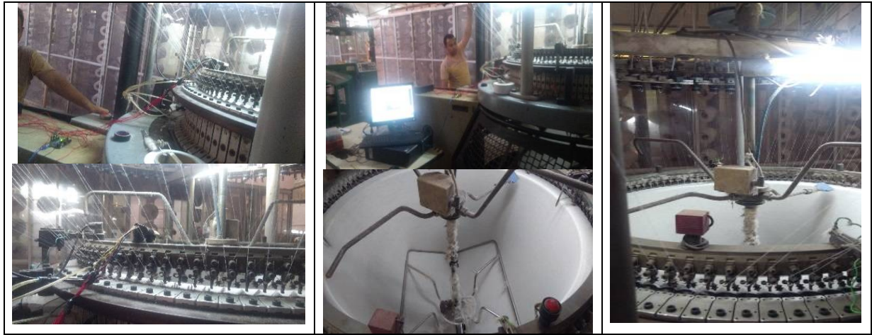
شكل (3) اوضاع مختلفة لتثبيت الكاميرا علي الماكينة لتحقيق أفضل رؤية للقماش 3- كما هو موضح في شكل (4) ونظرا لإمرار الاسلاك والتوصيلات من أعلي الماكينة فكان لزاما علينا تجهيز توصيلات إضافية من اجل زيادة الطول المتاح لتوصيلة الكاميرا مع عمل
