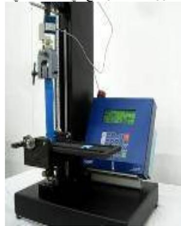
صورة رقم ( 1 ) توضح اختبار متانة الوصلة
