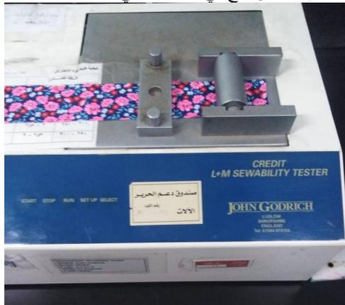
صورة رقم ( 3 ) توضح اختبار تعزيز إبرة الحياكة للقماش التريكو
