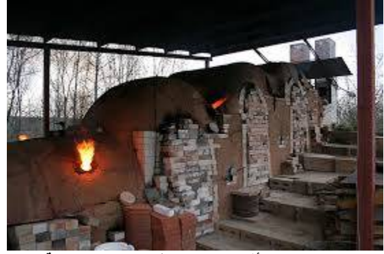
شكل (8) صورة للفرن أثناء الحريق وتظهر الفتحات الجانبية التي يتم تغذية الفرن بالخشب منها
