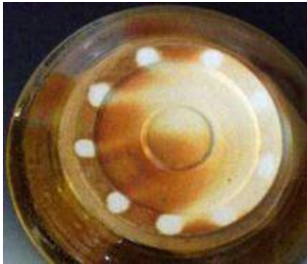
شكل (24) يبين العلامات الناتجة عن السنادات التي تم رص الطبقة عليها حتى لا يلتصق بأرضية الفرن
