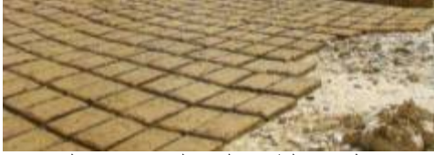
( شكل ٢ ) الطوب الطيني المستخدم في البناء
