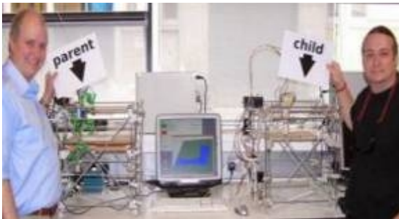
مشروع Rep Rap Project يعمل على طباعة الأجزاء المكونة للطابعة ثلاثية الأبعاد لصناعة آلة جديدة أو استبدال أحد أجزائها، أي أنها تصبح آلة تصنع نفسها بنفسها (32)
