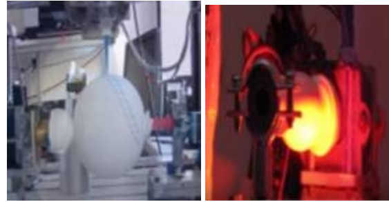
تجفيف بالونة السيليكون الهوائية وتطبيق مادة الفوتو بوليمر عليها
