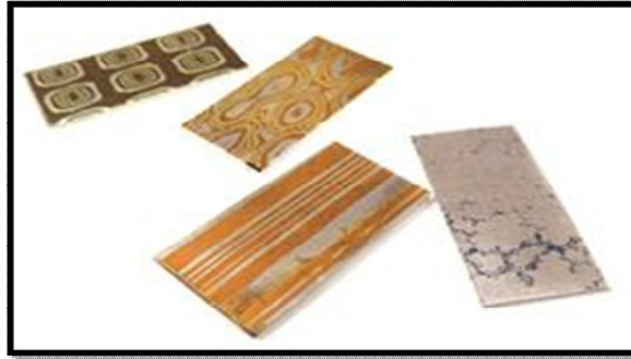
(شكل - 1) رقائق معدنية مصنوعة بطريقة الموكومي جاين، مصاغة تشكيمياً لتعطي أشكالاً ظاهرية مختلفة
