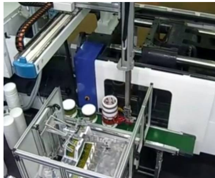
شكل ( 8 ) : وضع العبوة التي تم تشكيلها في المكان المحدد لها. يتم سريان الراتنج المنصهر في المسار المخصص في
