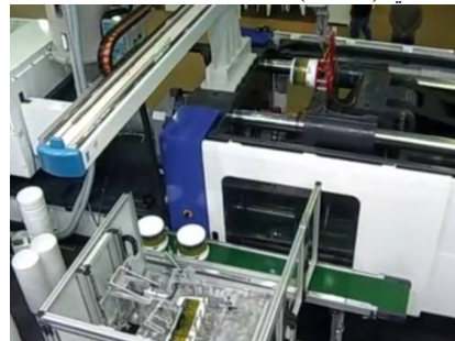
شكل ( 6 ) : تغذية الروبوت لماكينة الحقن بالبطاقة التي تم التقاطها.
