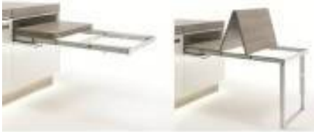
شكل (13) يوضح المجرى المعدني المثبت على جانبي الوحدة لفتح وإغلاق الأدراج؛ وأبعاد العجلة لتتيح لها سهولة النقل 2- طاولة طعام قابلة للضم تتكون من هيكل معدني منزلق بواسطة مجاري معدنية مثبتة بوحدة تخزين من الخشب؛ يثبت عليها ألواح خشبية قابلة للضم؛ ويتم تثبيت أرجل أمامية في مقدمة الطاولة ويتم تثبيتها عند ضمها.
