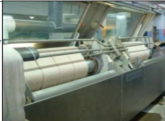
شكل (١١) ماكينة مرسرة الخيوط القطنية على هيئة شلال باستخدام الشدد (ماكينة التجارب العملية).
