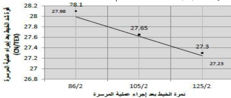
شكل (٢٠) معادلة خط الانحدار للعلاقة بين نمرة الخيط S بعد إجراء عملية المرصرة، وقوة شد الخيط (CN/TEX).
