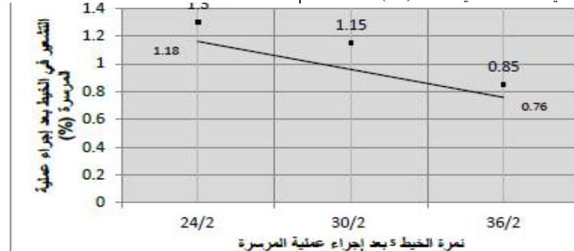
شكل (١٥) معادلة خط الانحدار للعلاقة بين نمرة الخيط S بعد إجراء عملية المرسرة، والتشعير في الخيط (%).
