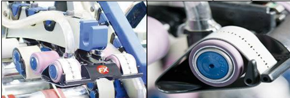
شكل (٣) الغزل المدمج باستخدام سير (بنظلون) إضافي علوي به ثقوب في المنتصف من تصميم شركة Zinser الألمانية.
