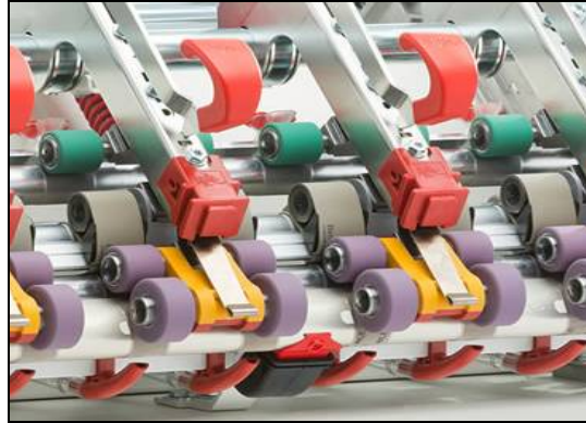
شكل (٤) الغزل المدمج باستخدام سير (بنطلون) إضافي سفلي به تقوب في المنتصف من تصميم شركة MAL الألمانية.
