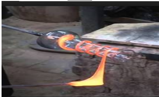
شكل 19 يوضح تشكيل الزجاج بالنفخ
