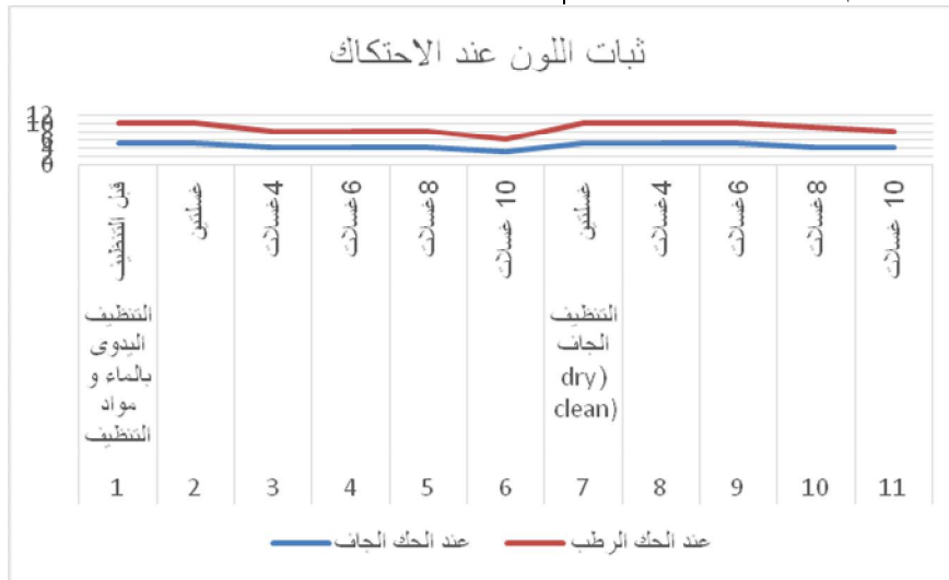
شكل رقم (١١) يوضح تأثير عدد مرات التنظيف على ثبات اللون عند الاحتكاك
