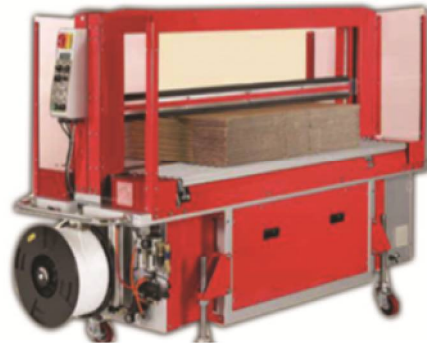
شكل (6) يوضح ماكينة تريبط وتحزيم الكرتون
