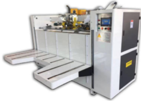
شكل (3) يوضح ماكينة دبوس الكرتون
