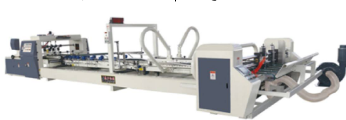
شكل (4) يوضح ماكينة طي ولصق عبوات الكرتون
