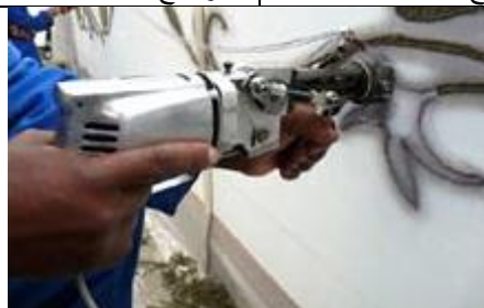
شكل (1) يوضح طريقة عمل أسلوب الوبرة نصف اليدوية
