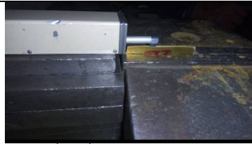
شكل رقم (2-a) يوضح تثبيت العينة.
