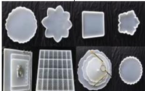
شكل رقم (٣) توضح بعض أنواع وأشكال القوالب المستخدمة في صب الريزن
