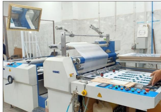
شكل (٣) إجراء عملية السلفنه على المنتج الطباعي
