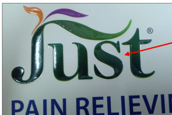
شكل (٤) ظهور الفقاعة الهوائية على اسم المنتج
