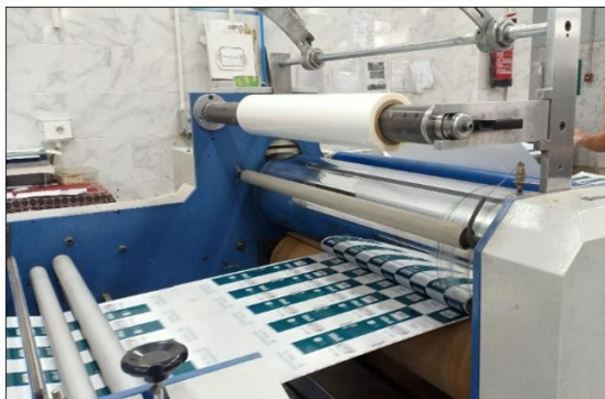
شكل (٣) إجراء عملية السلفنه على المنتج الطباعي
