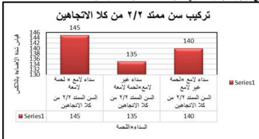
شكل (31) التحليل الإحصائي لنتائج اختبار قياس شدة الإضاءة لتجارب عينات تركيب السن الممتد 2/2 في كلا الاتجاهين
