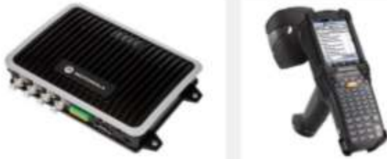
شكل (2) القارئ reader متحرك وثابت
