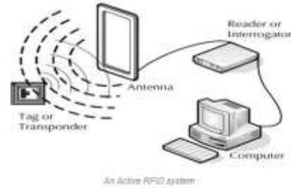
شكل (3) نظام RFID النشط
