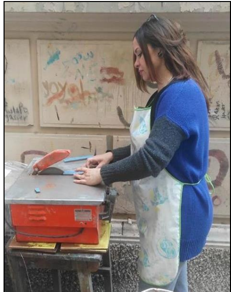
شكل (26) يوضح فك الغطاء الحاجز للماء للتمكن من مرور قطعة السيراميك والحصول على أطول خطوط ممكنة
