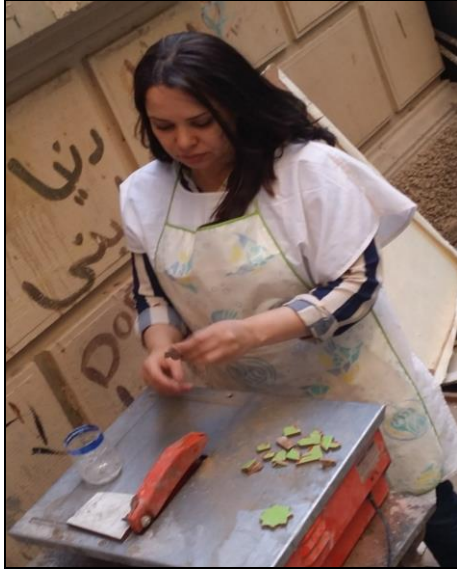
شكل (22) تشكيل الشكل النجمي على ماكينة التقطيع
