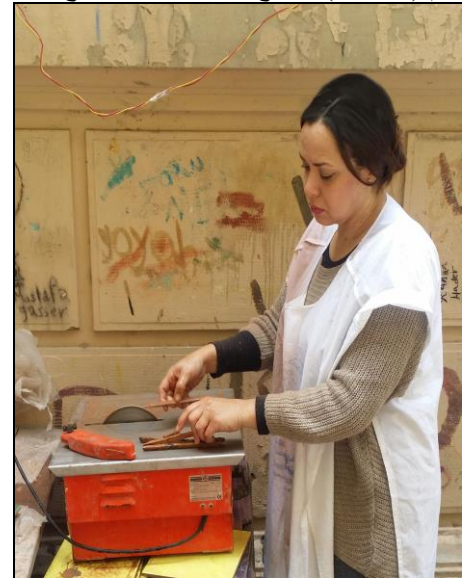
شكل (25) يوضح طريقة تثبيت قطعة السيراميك بشكل عمودي على سن التنجاسئين لضمان تشكيل خطوط مستقيمة
