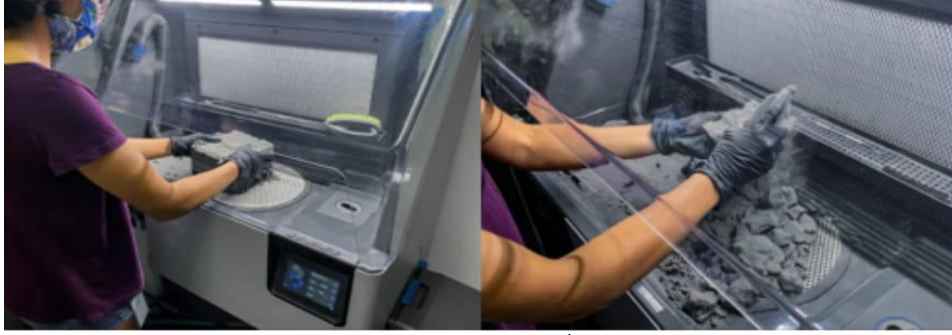
صورة (8) توضح إخراج أحد النماذج من طابعة التلييد الانتقائي بالليزر
