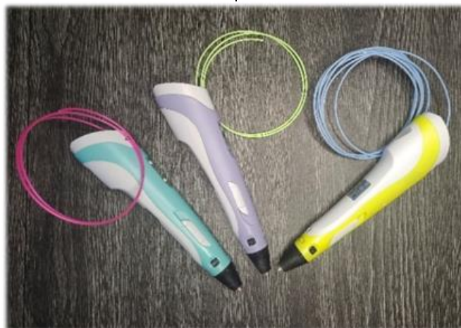
صورة (25) توضح أقلام الطباعة ثلاثية الأبعاد (بالترسيب المنصهر)
