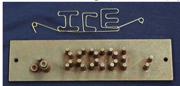
صورة (1) توضح قالب تثبيت الشكل الأصلي أثناء عملية تدريب سبائك ذاكرة الشكل
