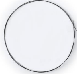
صورة (26) توضح سلك ذاكرة الشكل النيتنول سمك 1mm
