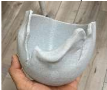
شكل 14 الجزء الأول من التصميم بعد طباعته بتقنية FDM وخامة PLA ذات الشكل الرخامي.
