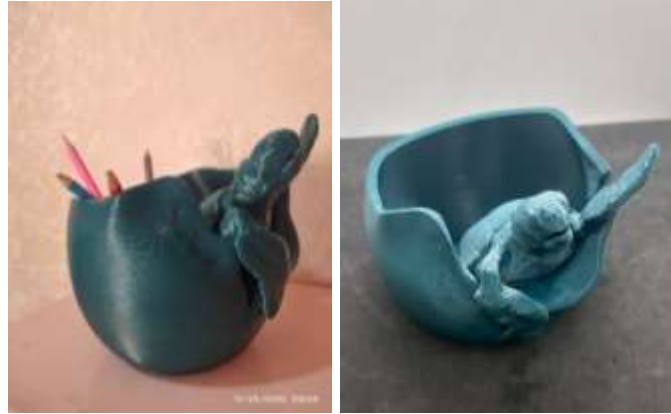
شكل 12 المنتج بعد الطباعة بتقنية FDM وخامة pla
