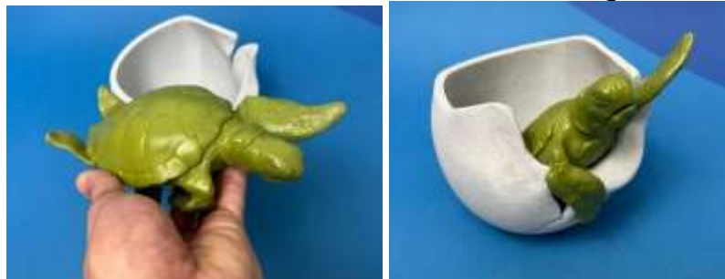
شكل 16 الجزء الثاني من التصميم بعد طباعته بتقنية DLP وخامة Standard ABS-like resin
