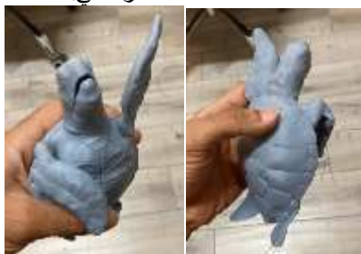
شكل 16 الجزء الثاني من التصميم بعد طباعته بتقنية DLP وخامة Standard ABS-like resin
