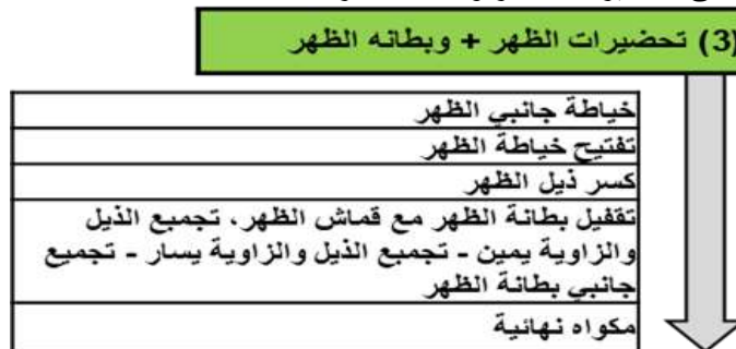
شكل (8) تتابع العمليات في خط تحضيرات الظهر وبطانه الظهر تم قياس الوقت القياسي للعمليات في خط تحضيرات الظهر وبطانه الظهر، كما هو مبين في جدول (3).
