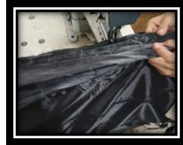
صورة (22) (أ، ب) تجميع البطانة مع الجسم الخارجي للحقيبة
