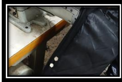
صورة (22) (أ، ب) تجميع البطانة مع الجسم الخارجي للحقيبة
