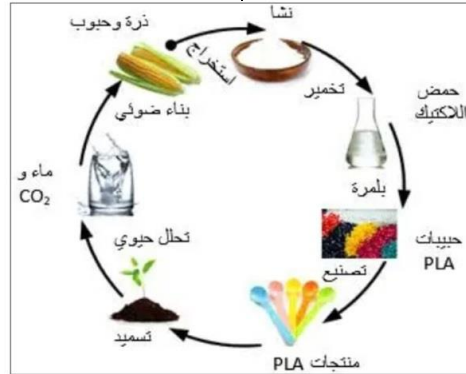
شكل (8) يوضح عملية تكوين البلاستيك الحيوي من النشا
