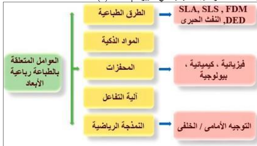
شكل (2) يوضح العناصر الأساسية للطباعة رباعية الأبعاد
