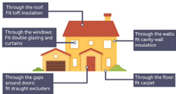
شكل 11 يوضح الطرق المختلفة لتسرب الهواء عبر عناصر التصميم
