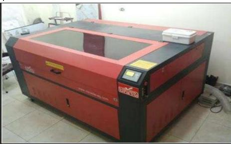
صورة (19) آلة القص بالليزر بتقنية التحكم (DSP)
