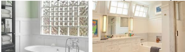
صورة 18، 19 توضح استخدام النوافذ ذات التعليق السفلي والطوب الزجاجي في الحمامات
