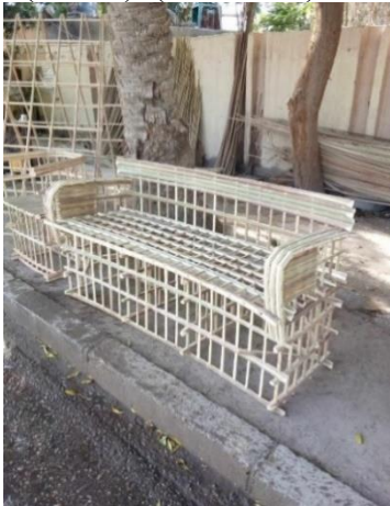
صورة (7) توضح كنبه صناعة محلية من مادة جريد النخيل تصوير الحرفي السيد سليم رحيم سلمان الحطاب
