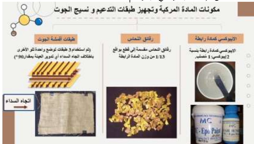
شكل (20) يوضح مكونات المادة المركبة وتجهيز طبقات التدعيم ونسيج الجوت
