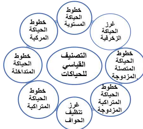
شكل (١) التصنيف القياسي BS 3870 لأشكال الحياكات (١١)
