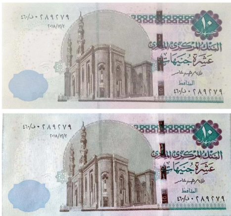
شكل رقم (٥) وجه فئة العشرة جنيهات مصري قبل وبعد تجربة مقاومة الزيوت
