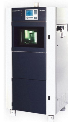
شكل رقم ( ١٤ ) جهاز قياس التقادم الضوئي والثبات اللوني
