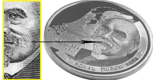
شكل (10) الطباعة الغائرة للرسم على سطح العملة المعدنية
