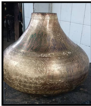
شكل 6: مرحلة العلام (الشكرة) وذلك برسم التصميم المطلوب باستخدام شوكة العلام بعد نقل التصميم من الورق باستخدام الكربون أو الرسم على المنتج مباشر .
