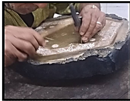
شكل 5: يوضح أولى خطوات التكفيت وهي تثبيت المنتج المعدني داخل القار عن طريق صب القار من الخلف وهو سائل والانتظار حتى يبرد تماماً أو الصب في الداخل إذا كان المنتج مجسم
