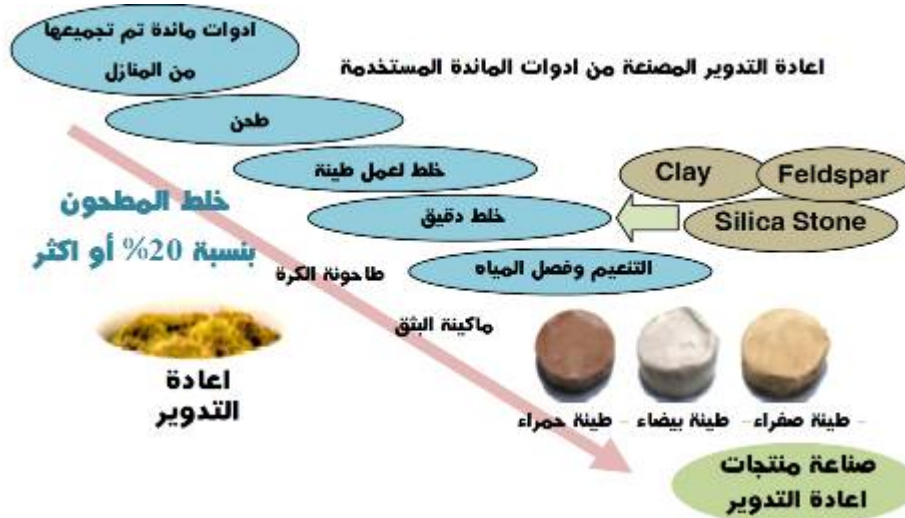
شكل (1) مراحل الانتاج و المواد الخام المستخدمة في صناعة ادوات المائدة المعاد تدويرها
