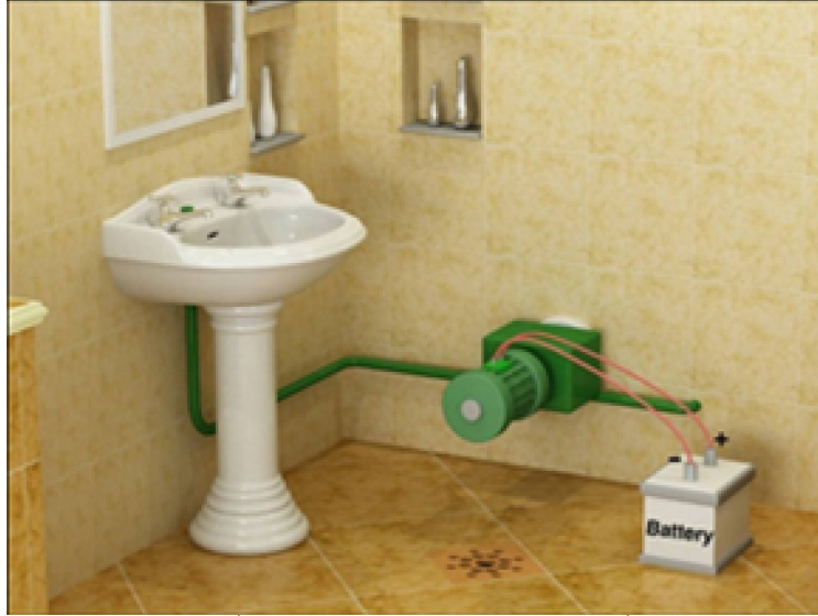
شكل (7): يوضح الوحدة المثبتة على مواسير الماء بها ريش المروحة و صندوق التروس و مولد الطاقة
