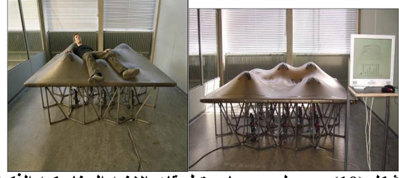
شكل (10) صور لمجسم باحد تطبيقات الابنيه الديناميكية الذكية التي تعمل علي راحة مستخدميه فتتخذ حوائطه الداخليه حركه متماشيه مع جسم المستخدم Michael Fox @ Art Center Puff
