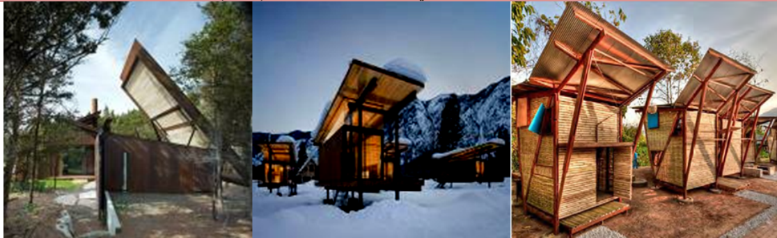
الشكل (8) صور المبني ذو سقف ديناميكي يتم فتحه لانارة بضوء النهار عند الحاجه من خلال حركه مركزيه
