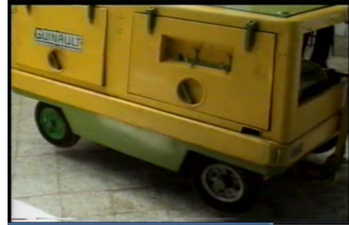
شكل رقم (3) يبين جهاز يحاكي الطريقة الجديدة وتوفر في المحاكي دورة هيدروليك كاملة ومماثلة للدورة المستخدمة في الشاحنات ، كما هو مبين في الشكل (4)
