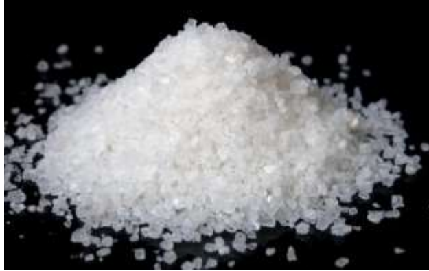
صورة (8) توضح الملح الصخري المستخدم في امتصاص الرطوبة
