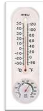
شكل (8) يوضح جهاز قياس الرطوبة ودرجة الحرارة داخل بيئة العبوة
