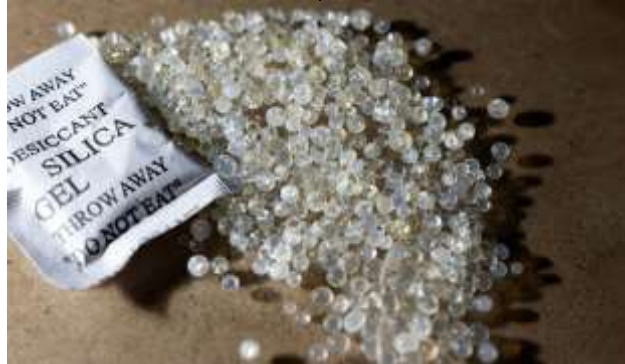
صورة (9) توضح جل السليكا المستخدم في عبوة التغليف الفعال
